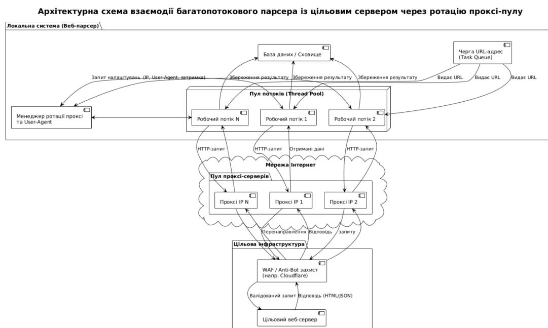
Рисунок 1 – Архітектурна схема взаємодії багатопотокового парсера із цільовим сервером через ротацію проксі-пулу
